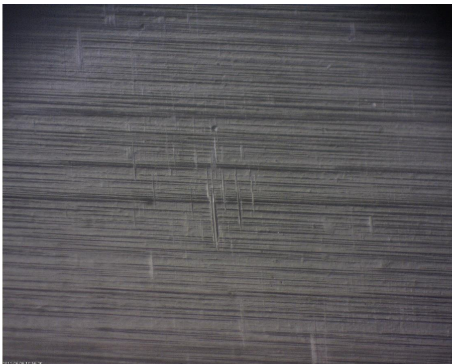
Imagem 5: Eixo principal antes do tratamento com REWITEC®
