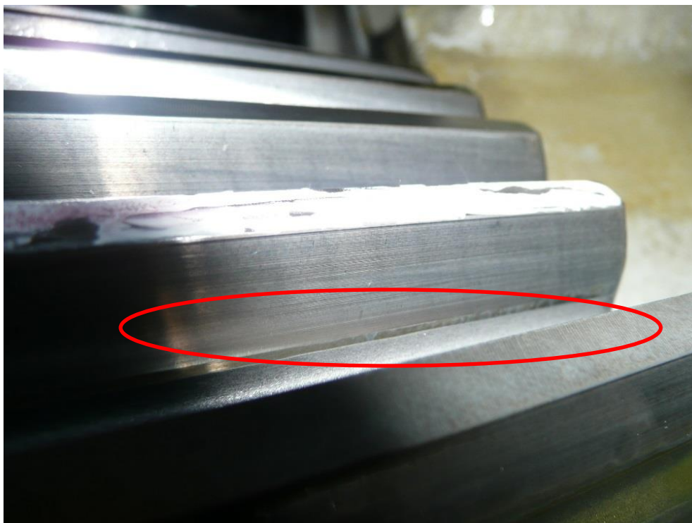
Imagens 3: Área onde os moldes foram retirados no aerogerador nº 1 depois do tratamento. Superfícies brilhantes e com reflexos são visíveis agora.
