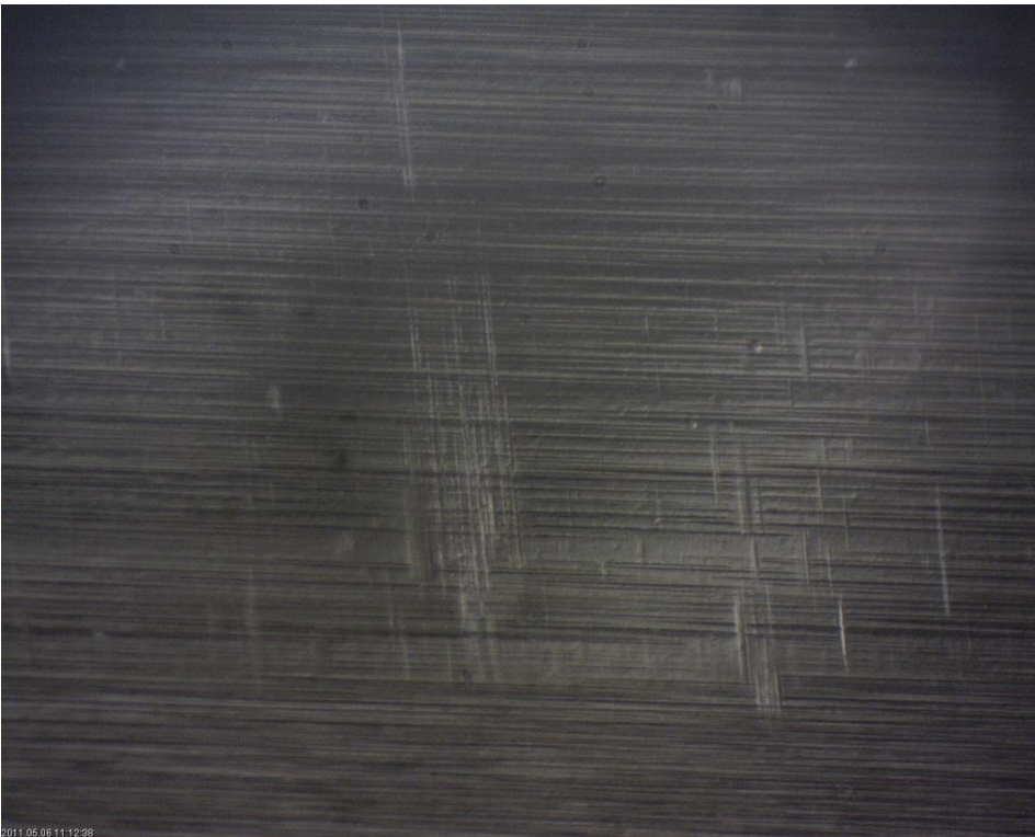
Imagem 7: Eixo principal antes do tratamento com REWITEC®
